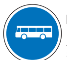
B27a Voie réservée aux véhicules des services réguliers de transport en commun.
