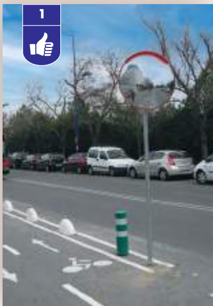
Exemple d'une bande cyclable protégée.
